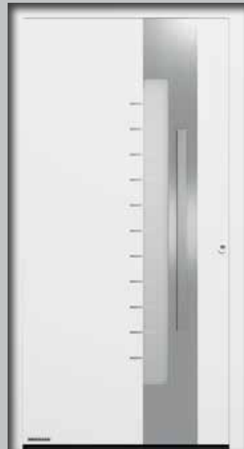
Мотив 560 Ручка из нерж. стали HOE 600, декоративный элемент из нержавеющей стали, стекло с мотивом: матовое Float с 11 прозрачными полосами, тройное теплоизоляционное остекление WSG, показатель U_D до 0,9 Вт/(м 2 ·К)*
