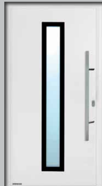
Мотив 600 ■ НОВИНКА с 1.7.2017 Ручка из нерж. стали НВ 38-2, с накладным остеклением: тройное изоляционное остекление, снаружи многослойное безопасное стекло VSG, посередине Float, подвергнутое пескоструйной обработке, изнутри прозрачное однослойное безопасное стекло ESG, показатель U_D до 0,98 Вт/(м 2 ·К)*
